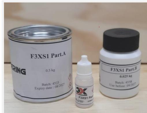
Le mastic F3XS1 est un époxy renforcé céramique. Le F3XS1 offre une très haute qualité mécanique pour les réparations de canalisations endommagées par des fissures, de la corrosion, de l'abrasion, des chocs ou des contraintes chimiques.
